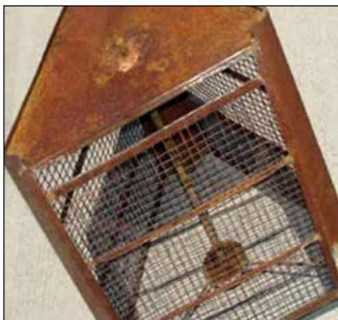
Rozdiel medzi otryskaným a neotryskaným povrchom
