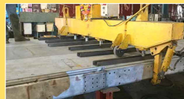
Hydraulický montážny prípravok pre montáž podlahy nákladných vagónov
