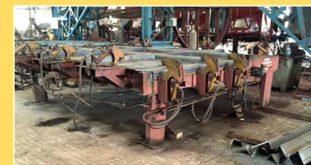
Montážno-zvárací prípravok pre bočnice nákladných vagónov s hydraulickým upínaním
